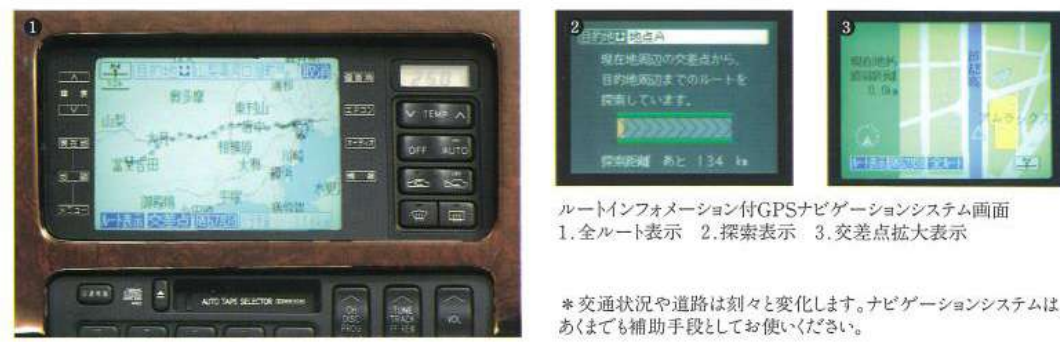
エレクトロマルチビジョンの画面（写真はGPSナビゲーションシステム付） 1. TV画面（画面はハメコミ合成） 2. ラジオ操作表示 3. ナビゲーションマップ 4. 方位・航続可能距離 5. エアコン操作表示
