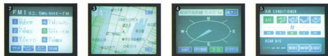
エレクトロマルチビジョンの画面（写真はGPSナビゲーションシステム付） 1. TV画面（画面はハメコミ合成） 2. ラジオ操作表示 3. ナビゲーションマップ 4. 方位・航続可能距離 5. エアコン操作表示
