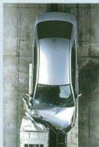
オフセット前面衝突実験 (64km/h、写真は乗客用の試作車)
