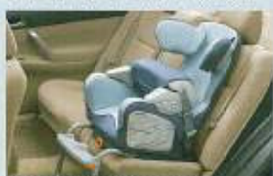
ISOIX対応チャイルドシート固定時
