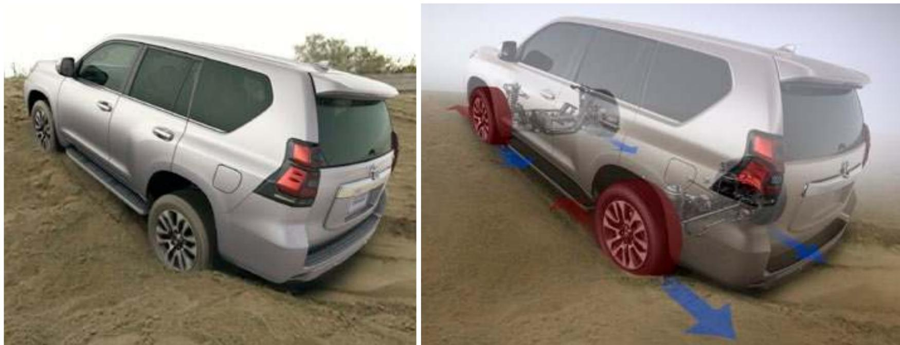
クローコントロールシステム作動イメージ（スタック状態からの後退脱出）
