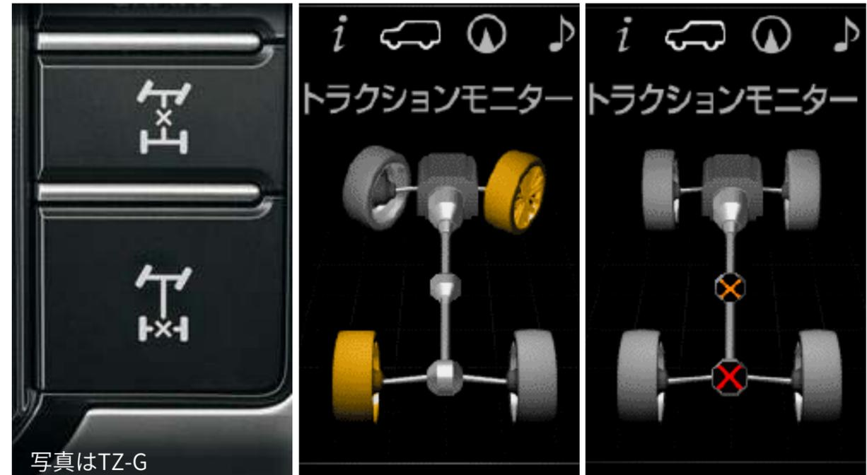
電動センターデフロックスイッチ & 電動リヤデフロックスイッチ
