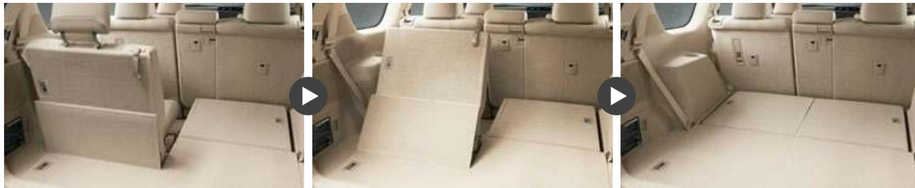
格納スイッチを一度押すと、シートバックが垂直位置まで移動。
