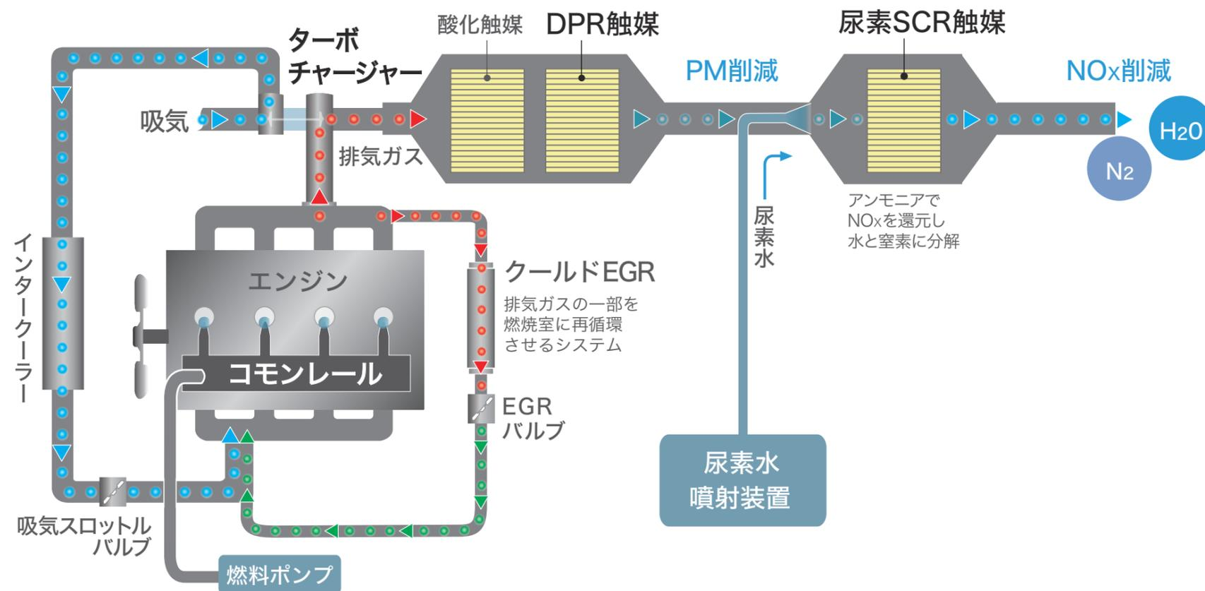
▶**コモンレール式燃料噴射システム**
