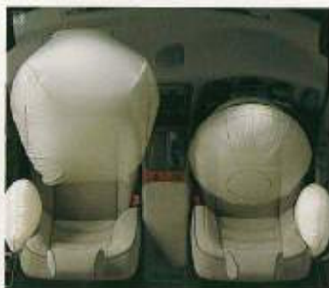
※写真は衝突直後の様子です。エアバッグは衝突時に展開し、乗員の頭や胸を保護します。なお、SRSサイドエアバッグは、衝突の衝撃時に衝突位置から展開します。
