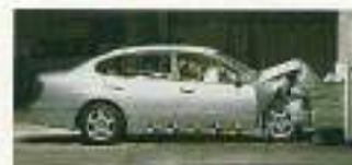
※フロント側面衝突試験(64km/h)。写真は衝突直後の様子です。
