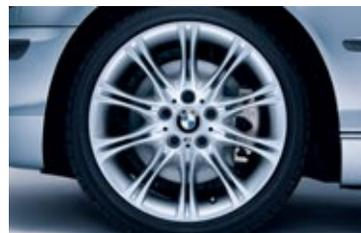
□ **BMW Leichtmetallräder Doppelspeiche 135M,** mit Mischbereifung, vorn 8 J x 18 Zoll, Bereifung 225/40 R 18, hinten 8,5 J x 18 Zoll, Bereifung 255/35 R 18.
