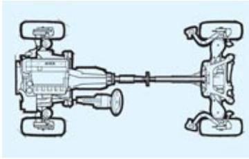
■ **Leichtbaufahrwerk** mit Eingelenk-Federbein-Vorderachse und Zentrallenker-Hinterachse; für hervorragenden Bodenkontakt und höchste Fahrsicherheit bestehen viele Fahrwerksteile aus Aluminium.
