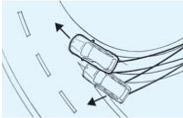
■ **Dynamische Stabilitäts Control (DSC)** inkl. CBC und DBC (Dynamische Bremsen Control): DSC erkennt eine Schleudernegung im Ansatz und stabilisiert das Fahrzeug innerhalb von Millisekunden. Die Unterfunktion Traktionsmodus erlaubt erhöhten Radschlupf, um situationsabhängig den Vortrieb zu optimieren und sportlicheres Fahren zu ermöglichen.
