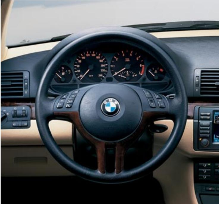
□ **Multifunktion für Lenkrad**, für Geschwindigkeitsregelung und Fernbedienung für Radio bzw. Telefon – hier abgebildet Sport-Lederlenkrad, drei Speichen.
