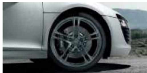
Aluminium-Schmiederäder Audi exclusive im 5-Doppelspeichen-Design, in Titanoptik, Größe 8,5 J × 19 vorn, Größe 11 J × 19 hinten, mit Reifen 235/35 R 19 vorn und 305/30 R 19 hinten. Ein Angebot der quattro GmbH
