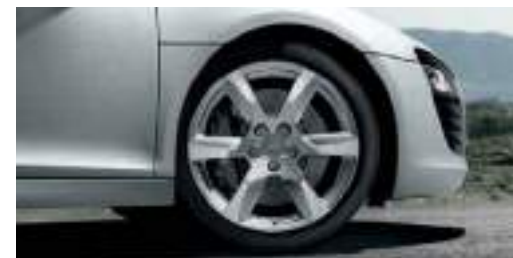
Winter-Aluminium-Gussräder im 6-Arm-Design, Größe 8,5 J × 18 vorn, Größe 10,5 J × 18 hinten, mit Reifen 235/40 R 18 vorn und 285/35 R 18 hinten, zulässige Höchstgeschwindigkeit 240 km/h, schnee- kettentauglich
