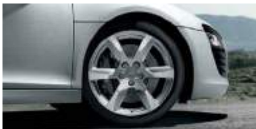
Aluminium-Gussräder im 6-Arm-Design, Größe 8,5 J × 18 vorn, Größe 10,5 J × 18 hinten, mit Reifen 235/40 R 18 vorn und 285/35 R 18 hinten
