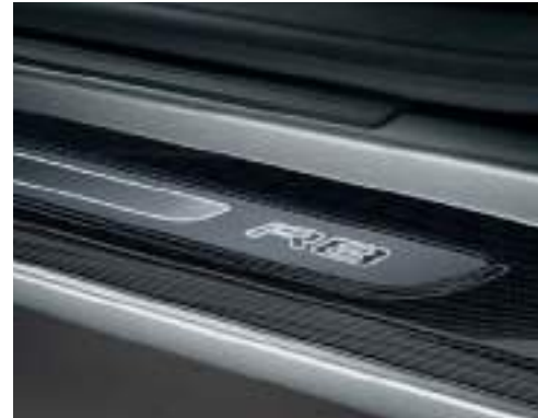
Einstiegsleisten in Carbon mit beleuchteter Aluminiumeinlage Audi exclusive Beleuchtet sind die innere Umrandung der Aluminiumeinlage und der R8-Schriftzug. Ein Angebot der quattro GmbH
