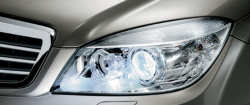
Intelligent Light System met bi-xenonkoplampen.
