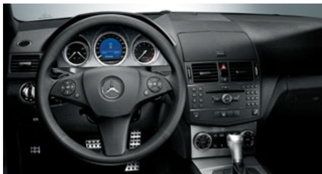
Achter het driespaaks lederen sportstuur zijn schakelpaddles aangebracht om bij de automatische transmissie met de hand te kunnen schakelen.
