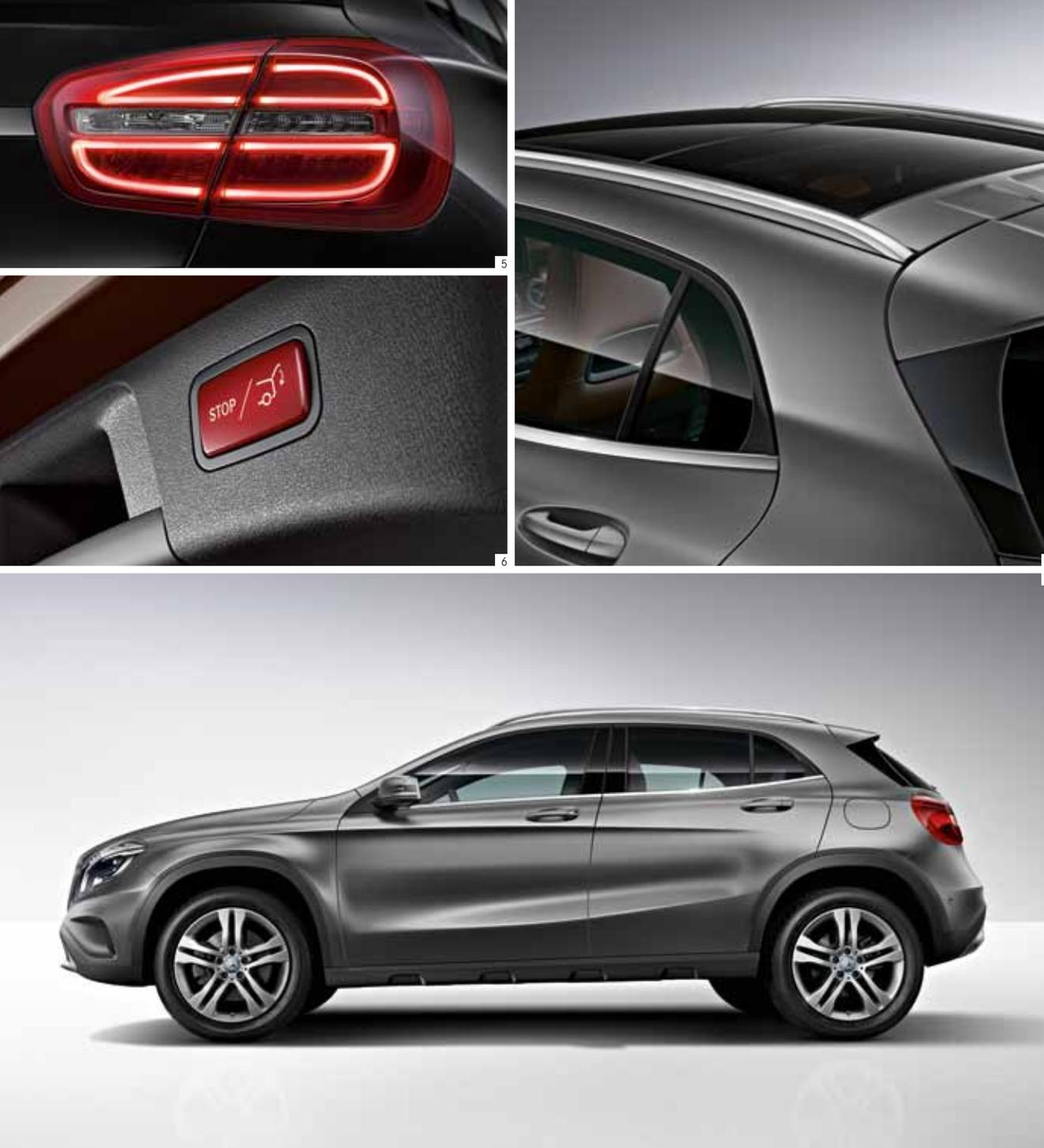
5 Los pilotos traseros de serie utilizan técnica de fibra óptica y se completan, en combinación con los faros bixenón opcionales o el **Intelligent Light System**, con intermitentes, luces de freno y luz trasera antiniebla en técnica LED.
