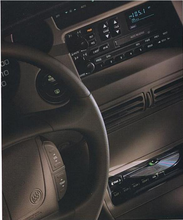
Le volant, avec ses commandes supplémentaires pour la radio et la climatisation, permet au conducteur de les régler aisément et en toute sécurité, sans quitter la route des yeux.
