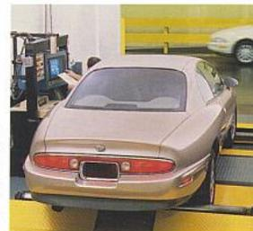
Pour le bon fonctionnement de chaque Riviera, chaque voiture est essayée sur un dynamomètre pour vérifier le régulateur de vitesse, la boîte de vitesses, l'antiblocage et le ralenti du moteur.
