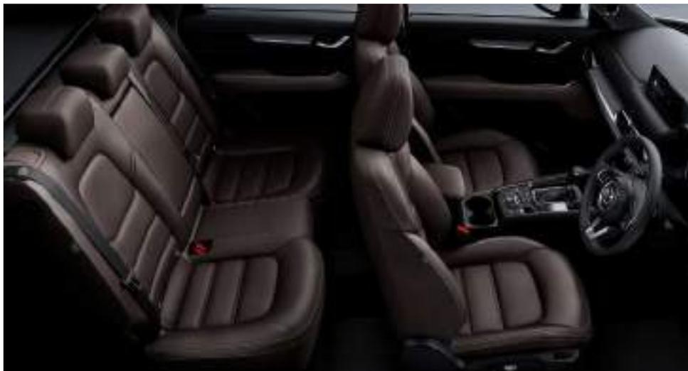
運転席10Wayパワーシートは、複数のシートポジションに加え、アクティブ・ドライビング・ディスプレイの設定を記憶できるメモリー機能を採用しています。いつも自分が使うキーに自分のポジションを記憶させておけば、解錠してドアを開けると自動的にそのポジションにセットされ、ドライバーごとのポジションが簡単に得られます。また、運転席 & 助手席シートヒーターが、寒い季節にもより快適な運転環境を提供します。
